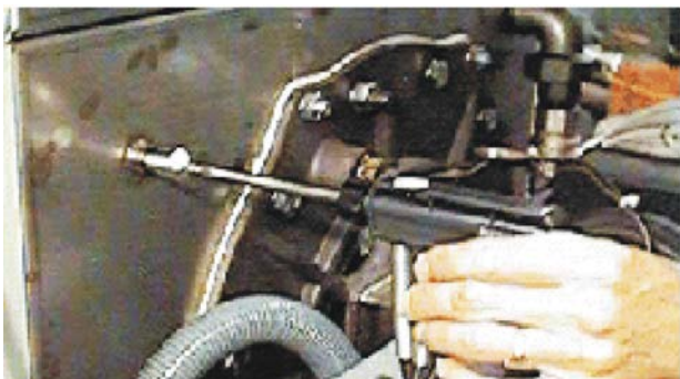
8.6.3 ábra - Füstgázelemző behelyezése
