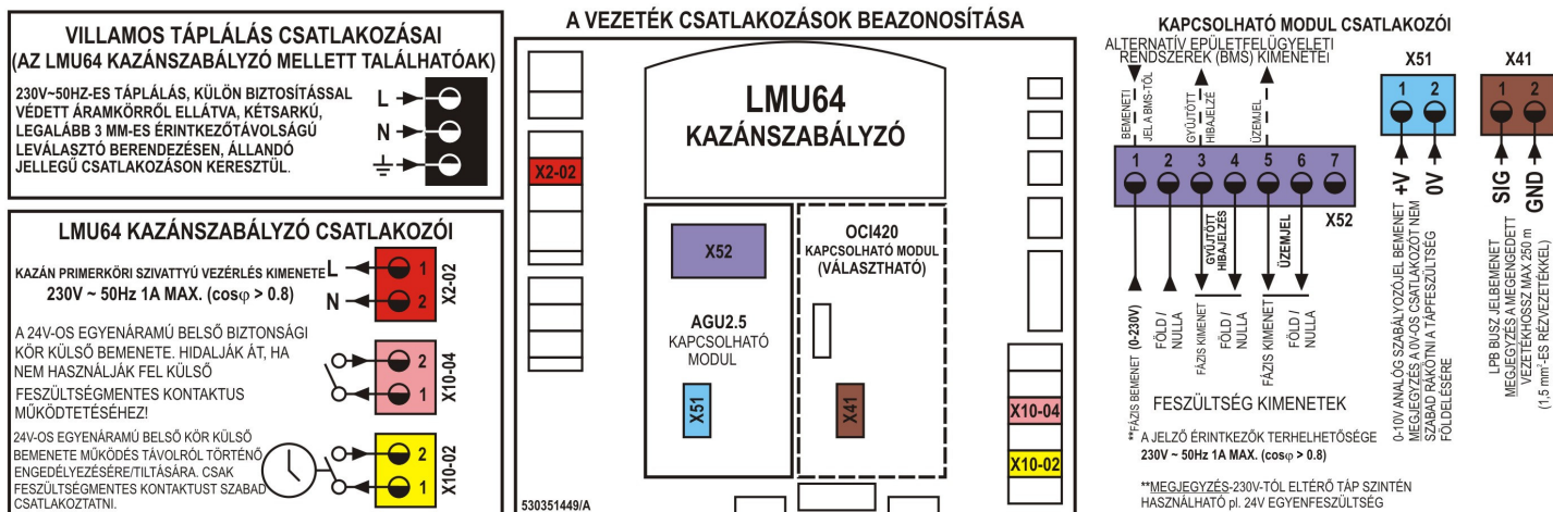
40. Ábra LMU64-es kazánszabályzó elektromos csatlakozásai
