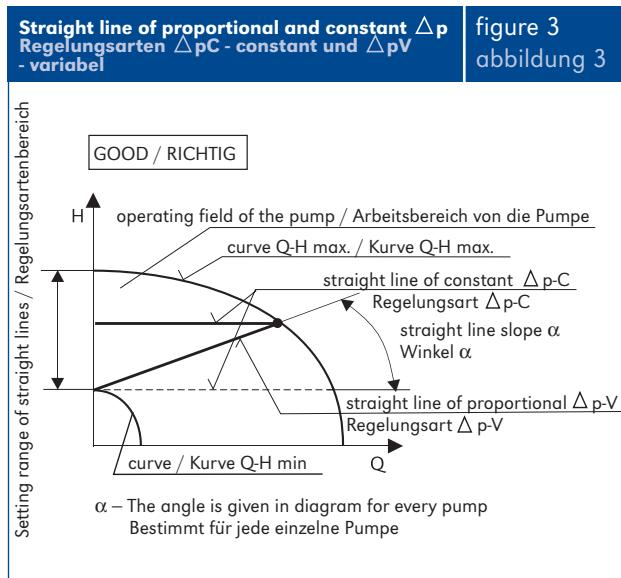
Das richtige Auswählen der regulierten Pumpen (Vergleichen der projektbedingten Charakteristika der Pumpe mit den tatsächlichen technischen Charakteristika einer Pumpe) ist auf Abb. 3, 4 und 5 dargestellt.
